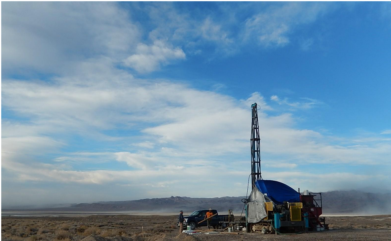
Abbildung 1 - Bohrer LF-70 am Standort CVZ-62, 17.11.2020, Brad Peek, Chefgeologie und qualifizierter Sachverständiger vor Ort, Blick Richtung Nordwesten. In Loch CVZ-62 ist ein 50 Meter breiter Abschnitt aus Lithium-Tonstein enthalten; die Bohrungen im Tonstein werden fortgesetzt. Proben wurden an das Labor von ALS Laboratories zur Analyse übermittelt.
